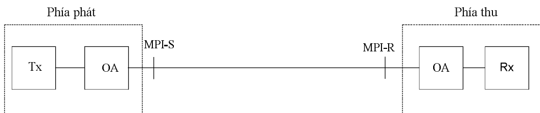
Hình 2 - Cấu hình chuẩn của giao diện quang đối với hệ thống có sử dụng khuếch đại quang
