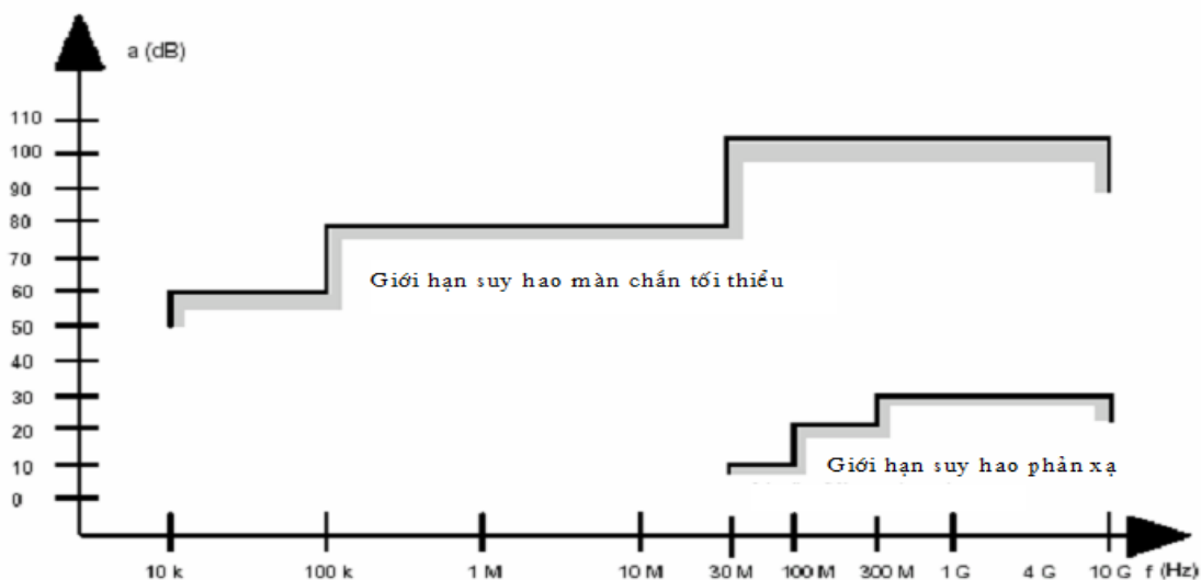
Hình A.3 – Đặc tả đối với suy hao phản xạ và che chắn
